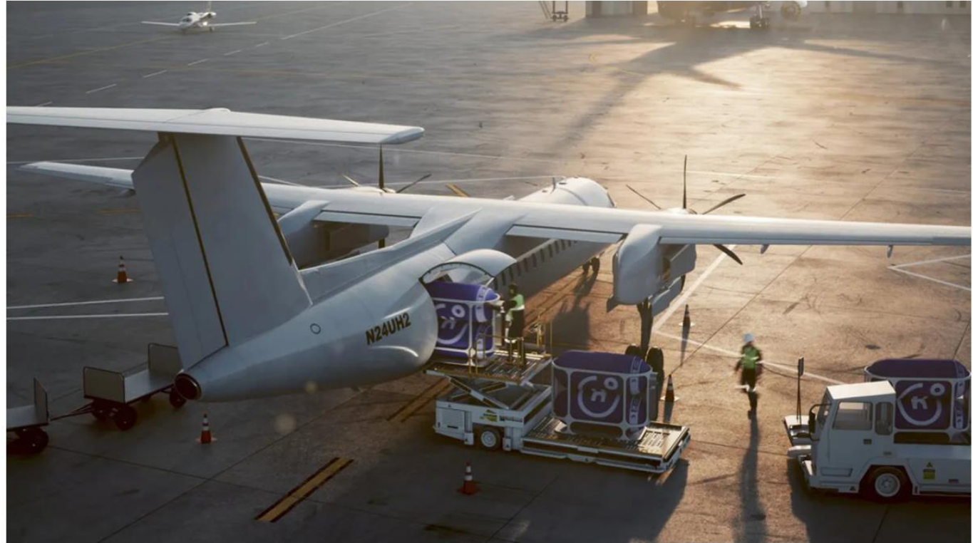
Le concept d'Universal Hydrogen est basé sur des capsules de H2 prêtes à l'emploi. (Universal Hydrogen)
